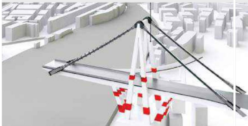
Le pile 10 e 11 saranno demolite con esplosivo. In rosso i punti dove saranno posizionate le cariche
