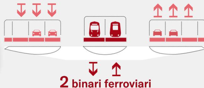
La stabilità aerodinamica è garantita da un tipo di impalcato che permette di sopportare venti fino a 270 km/h
